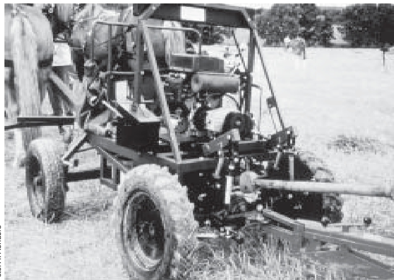
Ein Vorderwagen ermöglicht die Nutzung von Schleppergeräten
